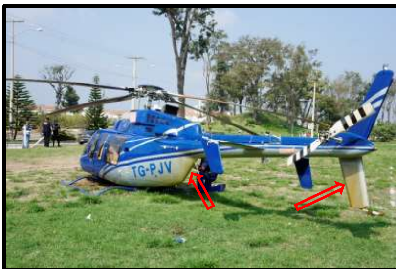
Fotografía No. 12 Fuselaje y botalón con mancha de aceite.
