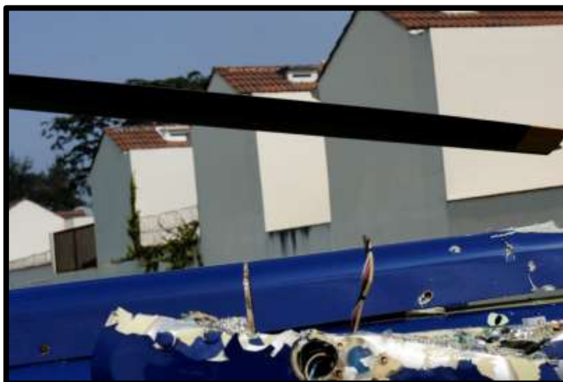
Fotografía No. 6 Vista de los impactos en el botalón de cola y del estabilizador.
